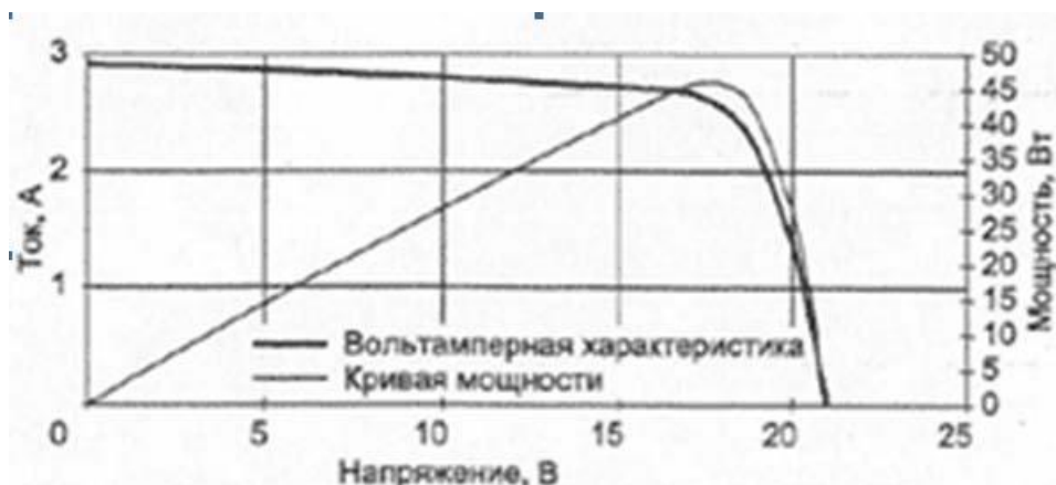
2.9-сурет -Күн батареясының вольт – амперлік сипаттамасы
